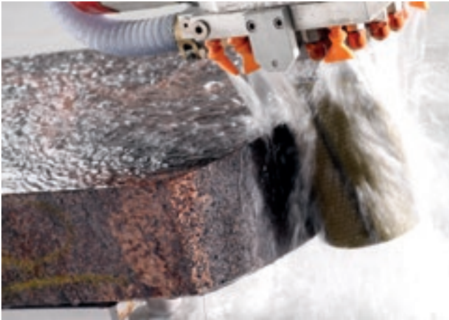
Meulage et polissage du chant de la dalle.
